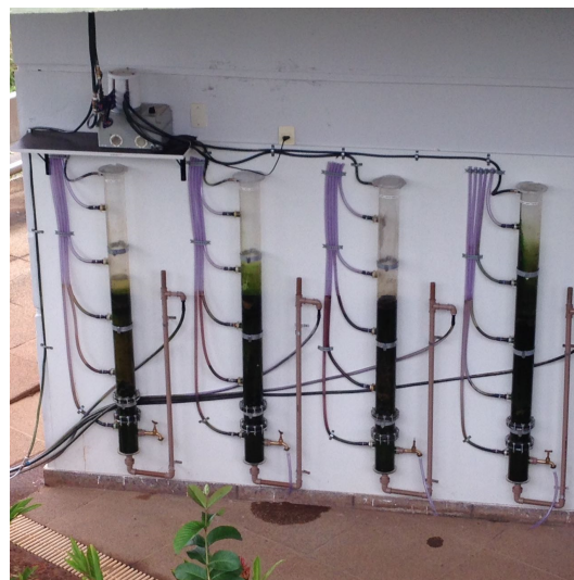
Figura 4.6 – Colunas de polimento em operação na ETE Arrudas
