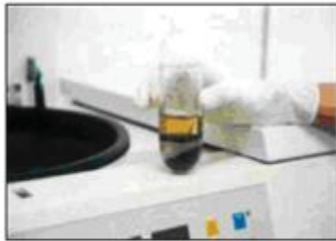
Separação das fases da amostra (tampão aceto acético e éter)
